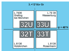
In Bayern berühren sich mit den angegebenen Blättern der Topographischen Karte 1:50 000 4 Zonenfelder
